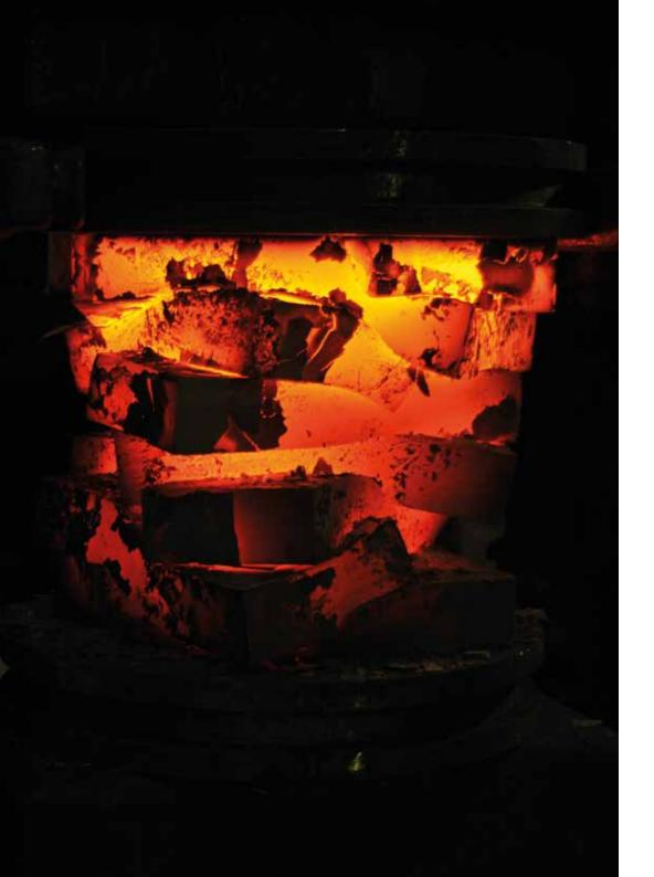
Die noch glühende **SCHICHTUNG ACHTFACH** kurz nach der Herstellung in der Freiformschmiede Hammerwerk Erft G. Diederichs GmbH & Co. KG.
